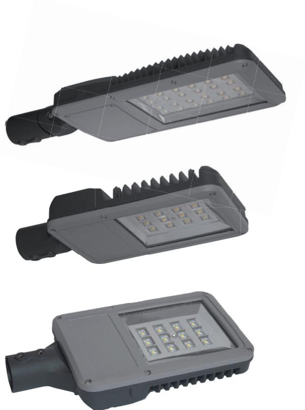
Gehäuse aus Druckguss-Aluminium mit Anti-Korrosions-Behandlung auf der Oberfläche in Verkehrsgrau RAL 7042. Sehr gute Leistungswerte und sehr gutes Wärmemanagement. Optimierte Ausrichtung der LED's für eine optimale gleichmäßige Ausleuchtung der Fläche. Für die Montage an einem Peitschenmast oder als Mastaufsatzleuchte (NEO LSL 20 mittels optionalen Adapters). Angenehmes Design, einfach zu installieren.
